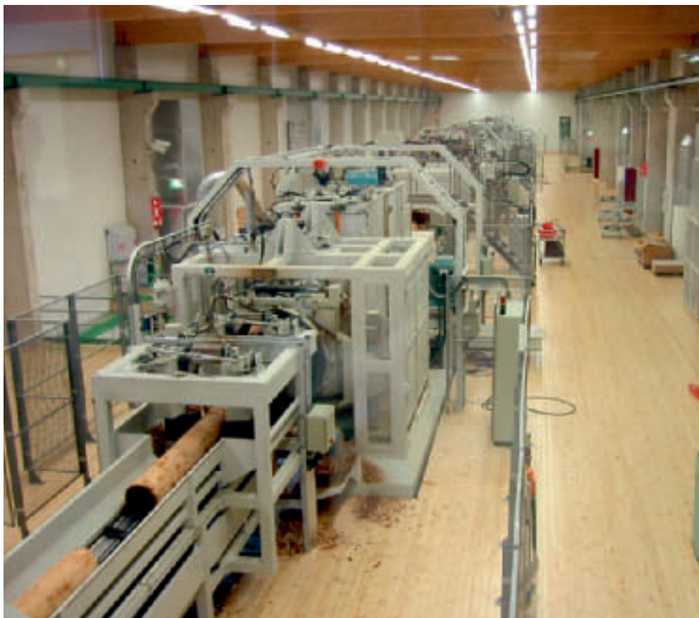
Kuvassa HewSaw SL250 Quartet sahalinja UPM:n Seikon sahalla Porissa. Sahalinja on asennettu vuonna 2002. Tukkikoko: 10–45 cm, syöttönopeus: 60–150 m/min, tuotantokapasiteetti: 400 000 m 3 /vuosi kolmessa vuorossa.
