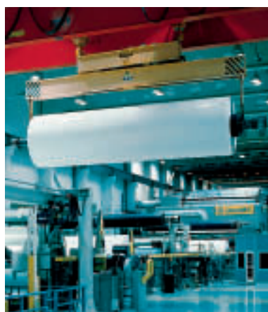
Paperikoneen konerullat ovat esimerkiksi 9 m leveitä, 50 tn painavia ja sisältävät paperia 100 km.
